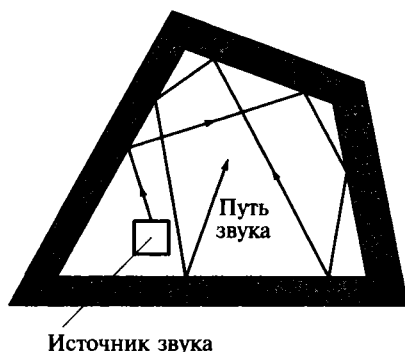
Рис. 12.5. Иллюстрация образования диффузности звукового поля
